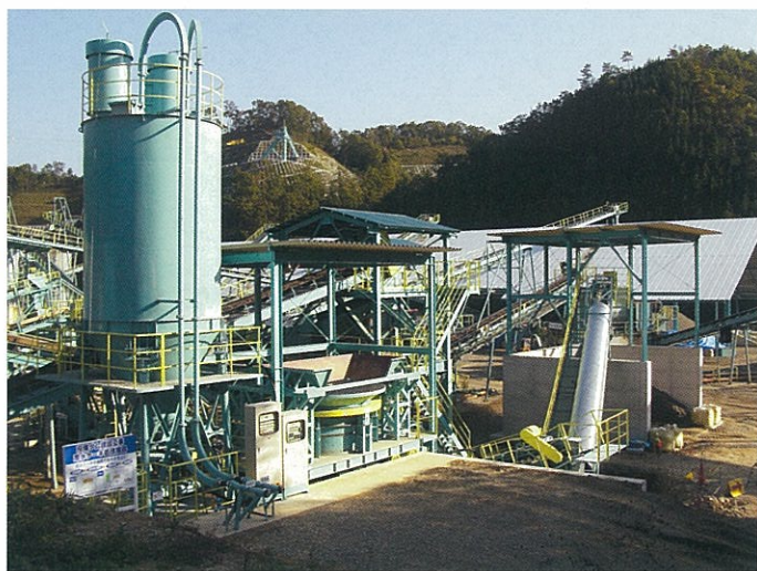
[ダム現場で稼働中のケークルII 50型]
