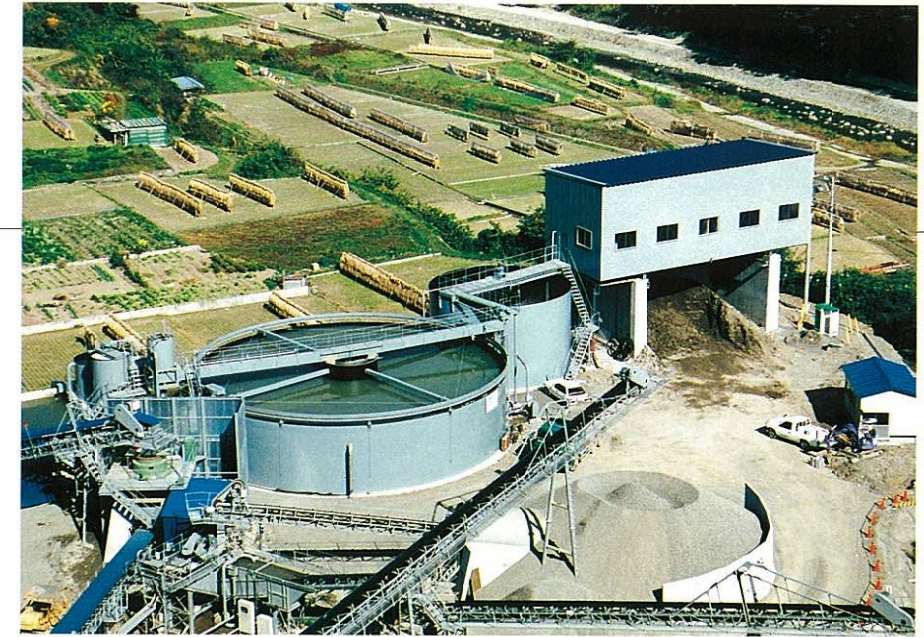
濁水処理装置 タイヤスロンシクナー フィルタープレス
