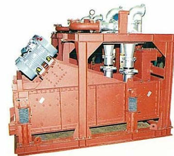
土砂分離装置
