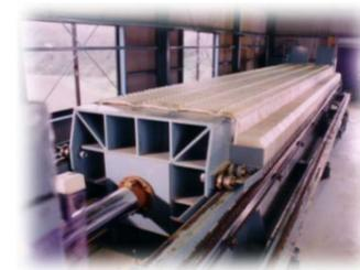
完全自動運転システムの採用。自動濾布洗浄機、PP板の選択可能。
