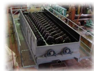
石などの固形物に付着した泥土を洗浄する。
