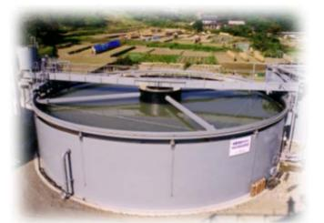
外輪駆動式により低動力化を実現。レーキ自動昇降機能付。
