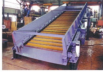
高含水率の原料も目詰まりせずに篩分 細粒土選別機『ハイテックスクリーン』
