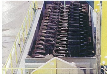
砂利等の表面の汚れをきれいに洗浄 泥土・泥塊排除装置『ログウォッシャー』
