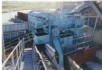
ゴミ混じりの砂利等からゴミを比重選別 砂利・ゴミ除去装置『流選ハイジェット』
