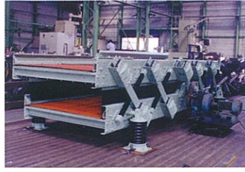
いろいろなサイズを正確に篩分 多目製品選別機『ツインサイザー』
