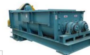
二軸式水平型混練機
